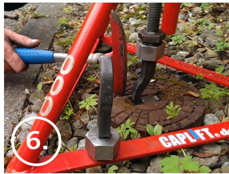
Bei extrem fest-sitzenden Kappen höhere Spannung aufbauen und durch einen gezielten Hammerschlag direkt auf die Kappe nachhelfen. Ein kurzer Schlag auf die, auf Zug gebrachte, Kappe reicht meist aus, dass die Kappe sich löst.
