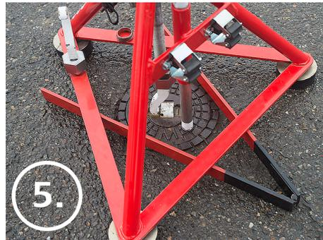
Bei extrem fest-sitzenden Kappen auf jeden Fall die Distanzschere als Niederhalter für den Einbautopf unterlegen und gegebenenfalls die Stellfüße durch Drehen korrigieren.
